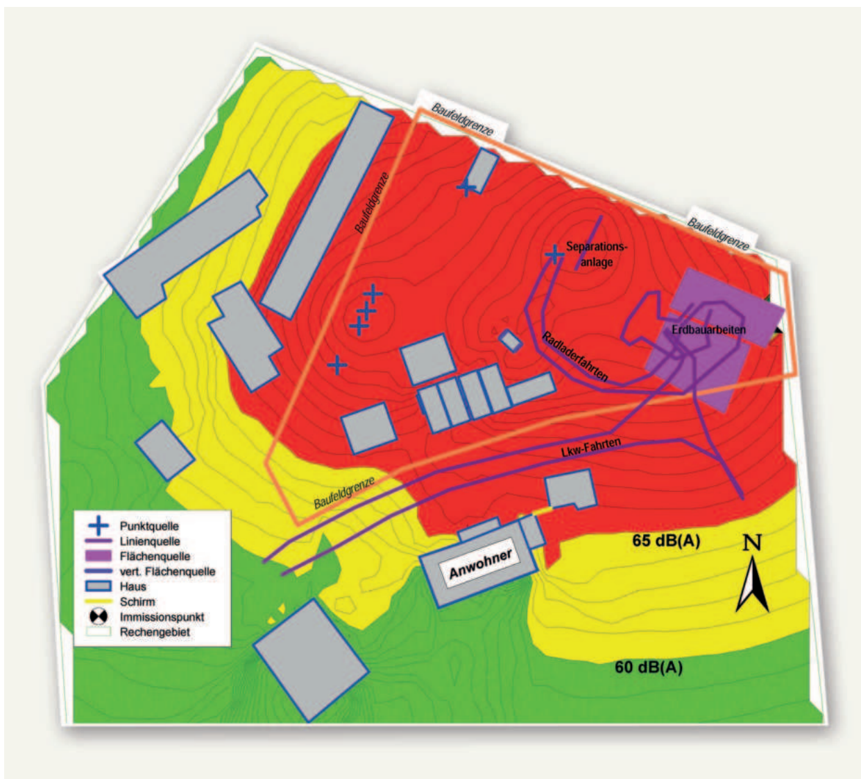
Abbildung 4: Beispiel für Baulärmprognose beim Anwohner – Berechnungsmodell 1 für Ausgangssituation
