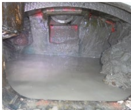
Abbildung 11: Blick durch Luke auf Rückansicht Schneidrad Quelle: BAK
